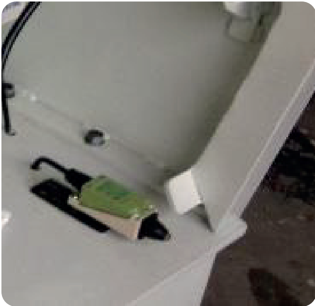
Imagen 4-13 Interruptor de seguridad para carcasa de protección
