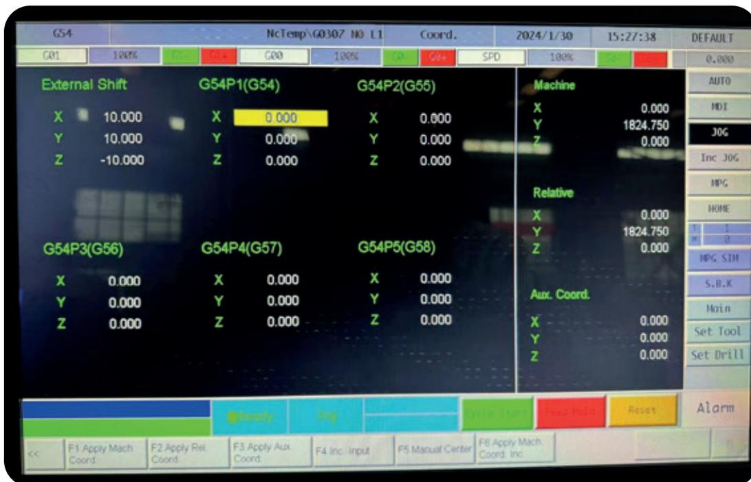
Ruta: F3 Desplazamiento/Ajuste → F1 sistema de coordenadas de la pieza
