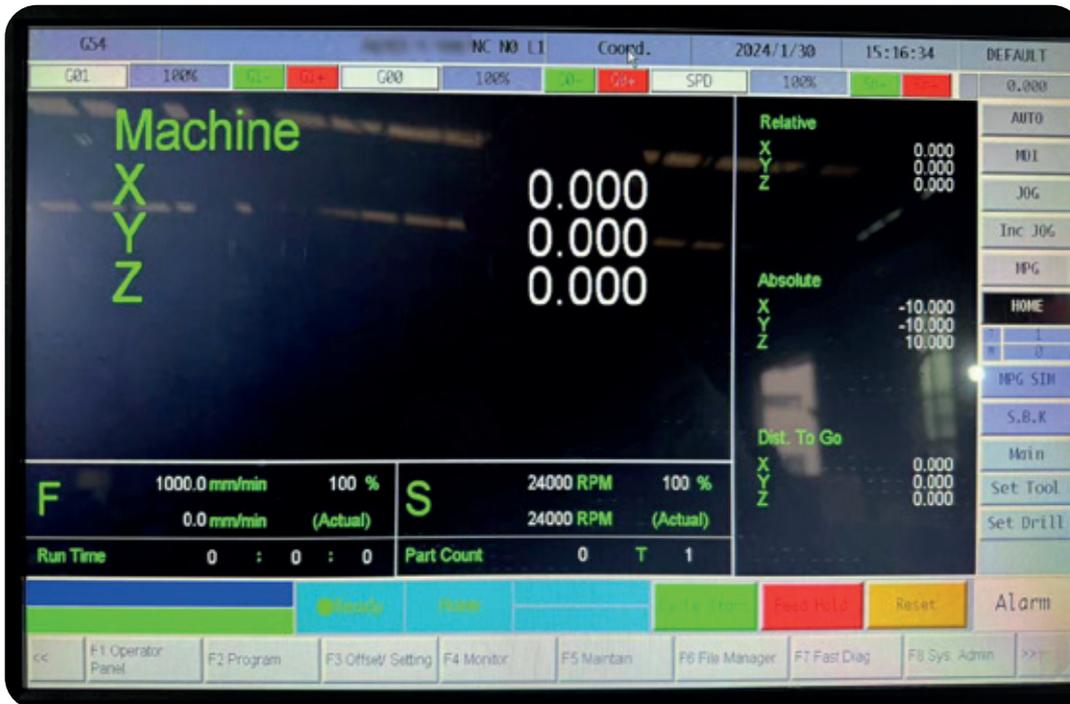
Pulse F1 para apagar la alarma. En el modo INICIO, pulse Inicio de ciclo. Cada eje de la máquina volverá automáticamente al origen mecánico, y la máquina herramienta iniciará inmediatamente la operación de retorno a cero. Una vez completado el retorno a cero, se puede llevar a cabo la operación de mecanizado.
