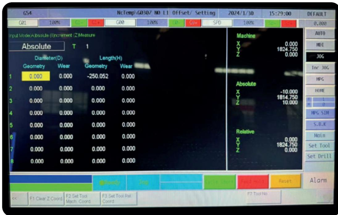
Ruta : F3 Desplazamiento/Ajuste→F2 Ajuste de herramienta
