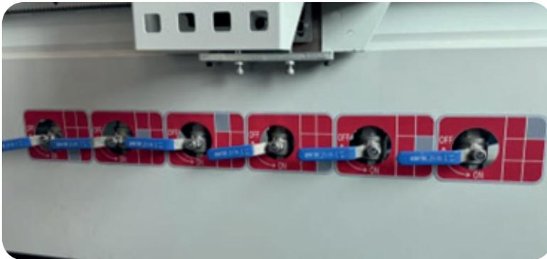
2. Utilice la presión negativa de la mesa de succión al vacío para adsorber el material en la superficie de la mesa de succión al vacío.
