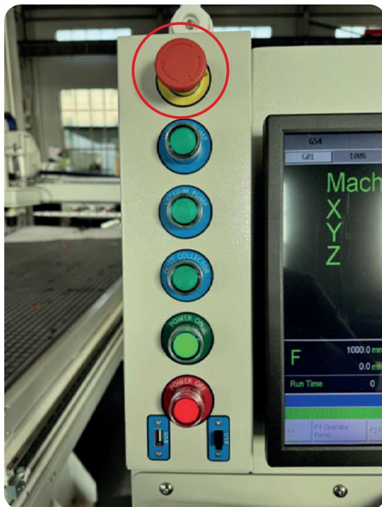
Después de encender la alimentación, puede juzgar el estado actual de la máquina observando la luz de señal. Por ejemplo, la ejecución de programas de procesamiento, el modo MDI, etc., se mostrará en verde, la pantalla de espera se mostrará en naranja, la alarma o presionar el interruptor de parada de emergencia se mostrará en rojo, etc., junto con la barra de estado del software determine el estado actual de la máquina.
