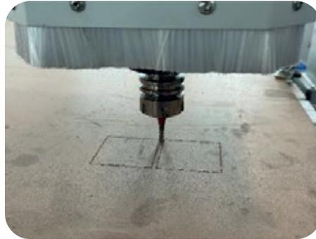
3. Abra F3 Offset/Configuración → F1 Sistema de coordenadas de pieza de trabajo, use el teclado para ingresar y use las teclas de dirección [↑] [↓] [←] [→] para mover el cursor al eje X de coordenadas G54 o haga clic en [Workpiece Coordinate System] con el mouse. Haga clic en [F1 Mechanical Coordinate Teaching] y seleccione [OK], Se establece el origen de la pieza de trabajo del eje X., Mueva el
