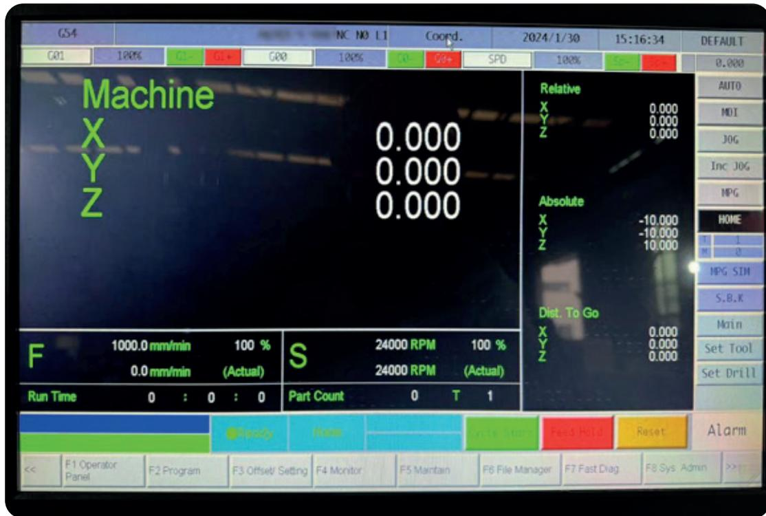
Presione F1 para apagar la alarma. En el modo INICIO, haga clic en Iniciar ciclo. Cada eje de la máquina volverá automáticamente al origen mecánico y la máquina herramienta iniciará inmediatamente la operación de retorno a cero. Una vez completada la devolución a cero, se puede realizar la operación de procesamiento.
