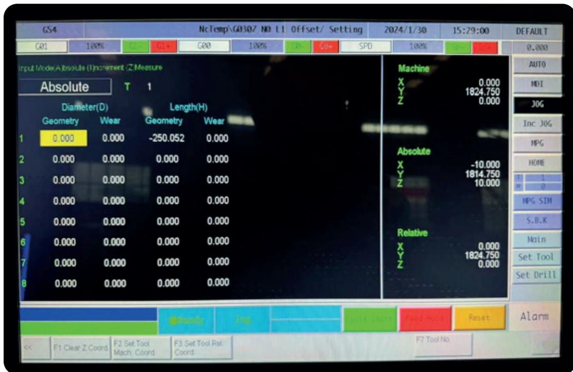
Ruta: Desplazamiento/Configuración F3 → Configuración de herramienta F2.
