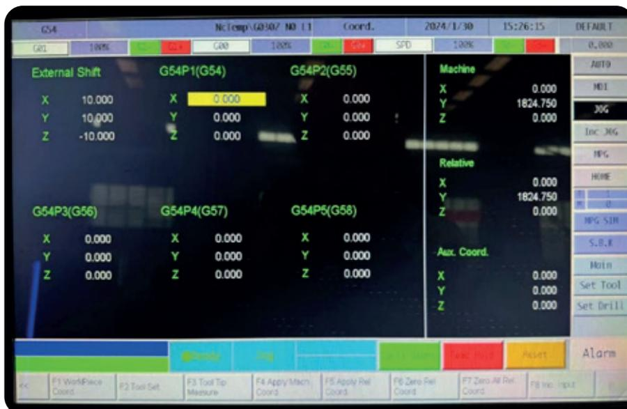
cursor al eje Y de coordenadas G54 y realice la misma operación para establecer el origen de la pieza de trabajo del eje Y. (El valor del eje Z en la pantalla es para depuración y no se puede utilizar como referencia).
