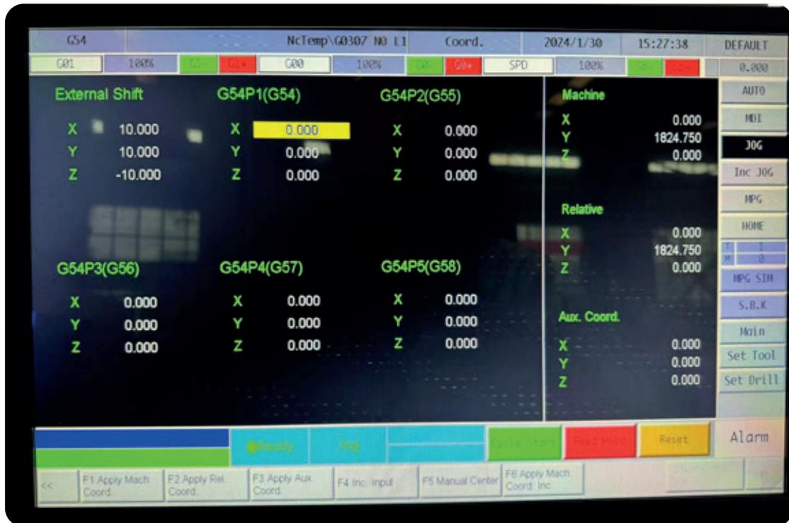
Ruta: F3 Desplazamiento/Configuración→F1 Sistema de coordenadas de pieza de trabajo.
