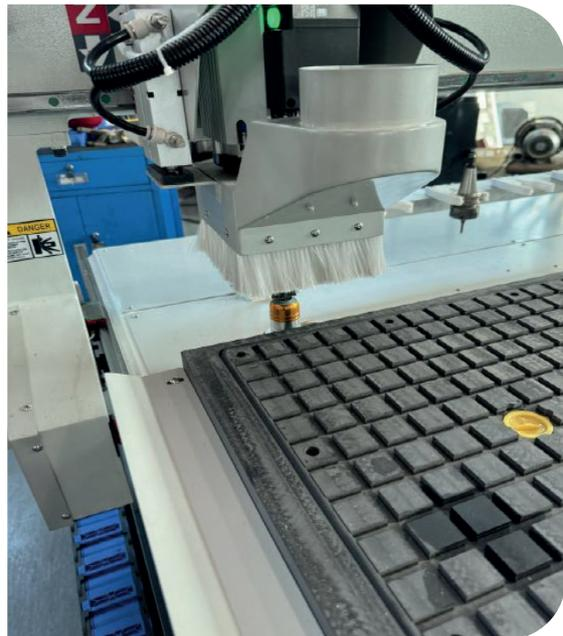
② Presione la tecla "TOOL SWITCH" para cambiar la herramienta actual a la herramienta No. 2, y presione la combinación de teclas "TOOL SET" + "MENU" para realizar el cálculo de compensación de la dirección Z de la herramienta No. 2.
