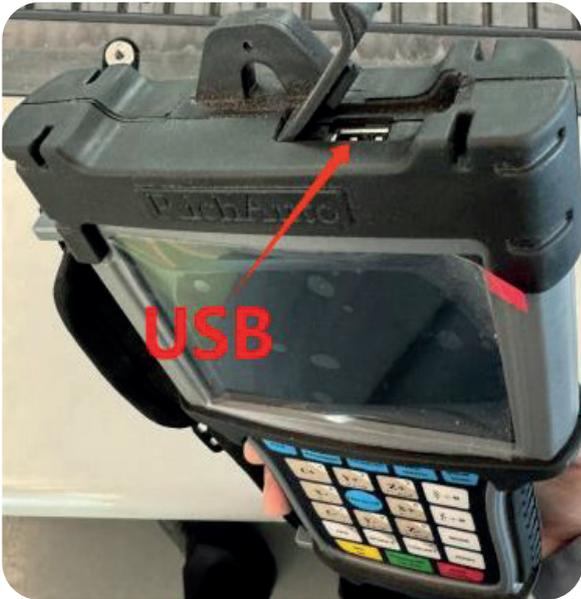
1) Importe directamente el archivo de procesamiento al disco U y luego ejecútelo con el disco U insertado en el controlador. Presione la tecla "FILE", la pantalla muestra:
