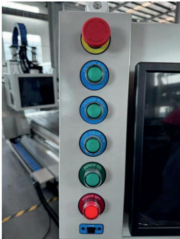
Después de encender la alimentación, también puede ver el estado actual de la máquina observando la luz de señal. Por ejemplo, las coordenadas mecánicas se mostrarán en verde cuando se complete el retorno a cero, en naranja durante el proceso de retorno a cero, en rojo cuando haya una falla o cuando se presione el interruptor de parada de emergencia, etc., de acuerdo con la barra de estado del software, para determinar el estado actual de la máquina.
