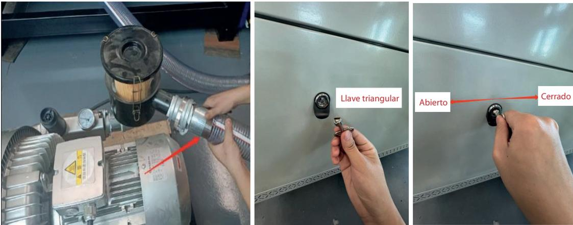
5.1.2. Abra la tapa del motor y conéctelo a la fuente de alimentación, y conecte el otro extremo al cableado de la bomba de vacío controlada por la máquina de grabado.
