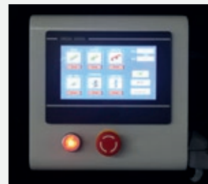
Panel de control con pantalla táctil de 7 pulgadas
