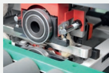
Ajuste de la unidad de recorte a través del contador, conveniente y rápido
