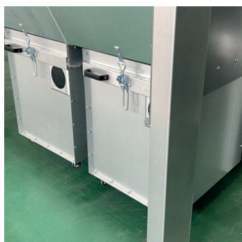
1. Contenedor de polvo con ventana de observación
